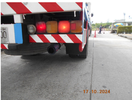
ภาพที่ 2.2-32 กรองประกายไฟ (Flame Arrestor)
